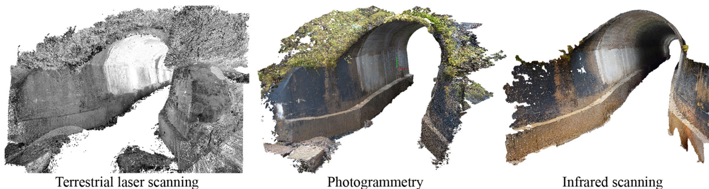
Figur 4: 3D modeller för bron över Kedkejokk – Påunabäcken – skillnader i detaljnivå mellan de olika utvärderade teknologierna.
